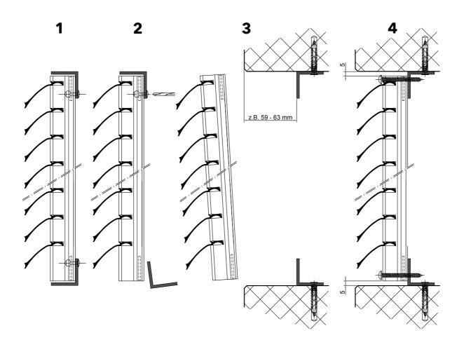
Falls Sie Montagewinkel zu den Wetterschutzgittern bei Alfitec bestellt haben, werden diese üblicherweise an das Gitter genietet **1**. Die Teile kommen zusammengebaut, um dem Verlust der Winkel in der Oberflächenbehandlung vorzubeugen.
